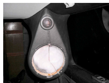
Часть объёма и здесь заполнена синтепоном
