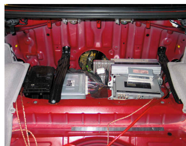
Процессору нашлось место в передней части багажника, у прорехи из-под штатного сабвуфера
