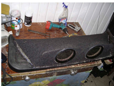
Карпет оказался очень удобным материалом для таких конструкций
