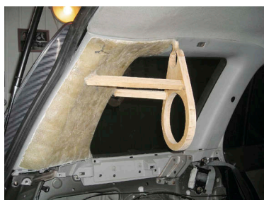
К стеклопластику крепится опорная плита излучателей
