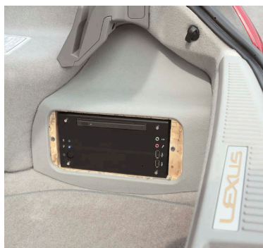
Компьютер расположился справа в багажнике и закрывается крышкой, туда часто лазить и не надо, всё по Wi-Fi
