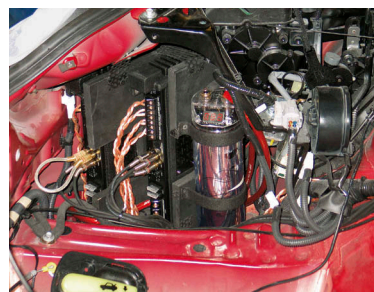
Усилители заняли то небольшое пространство, что осталось от механизма складывания крыши
