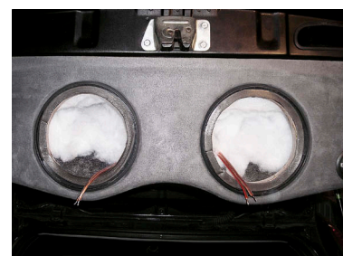
Внутри бокса закреплены кроссоверы, а около 40% объёма заполнено синтепоном
