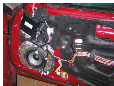
На место 60-миллиметрового среднечастотника ставится купольный, ненамного больших габаритов
